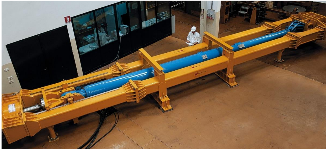
Vue d'un amortisseur pour essai à l'université de San Diégo (Californie)
