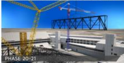
Mise en place de la méga poutre NORD
