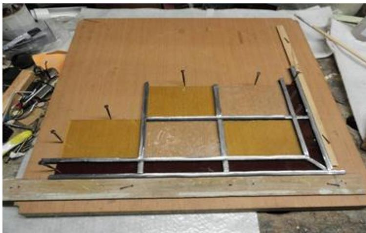
Mise en place des morceaux de verre qui sont maintenus provisoirement par des pointes spéciales en acier en attendant la pose des plombs.
