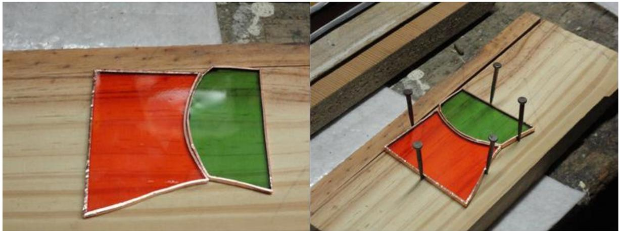
Mise en place des morceaux de verre et maintien par des pointes spéciales en acier
