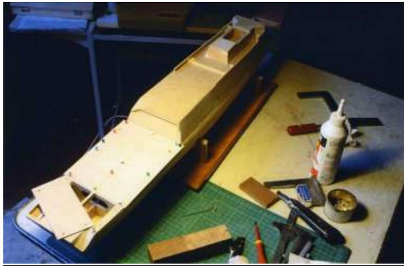
12. Profilage de la coque à l'enduit . Ponçage de finition
